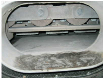
스케일 제거를 위하여 하는 청소는 설비 내부의 기기까지 청소하는 것은 모든 설비를 분해하여 청소하기 이전에는 물리적으로 불가능 하다.
